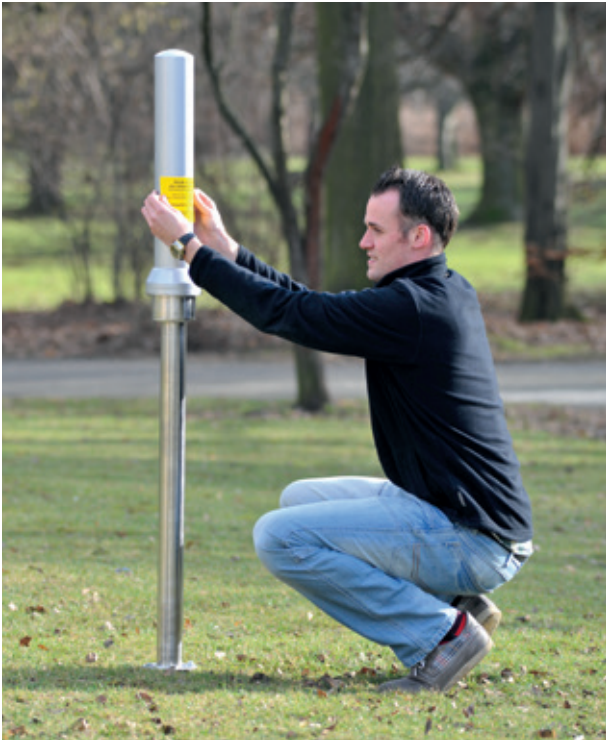
Mitarbeiter des BfS beim Auswechseln einer der rd. 1.800 Messsonden des IMIS.
