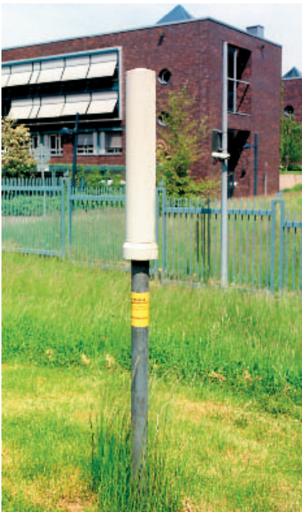
Sonde des Ortsdosisleistungsmesssystems
