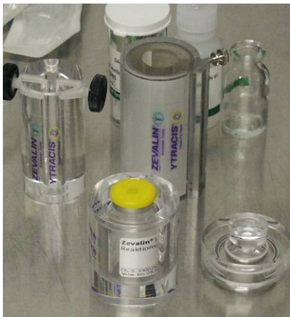
Abb. 1: Abschirmungen aus Acrylglas (Herst.: Biodex, Vertrieb: CIS Bio)
