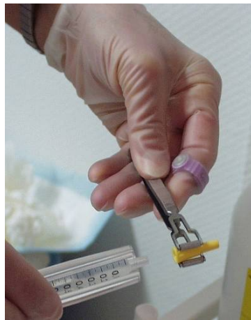
Abb. 5: Gebrauch einer Spezialpinzette und des amtlichen Fingerring- dosimeters
