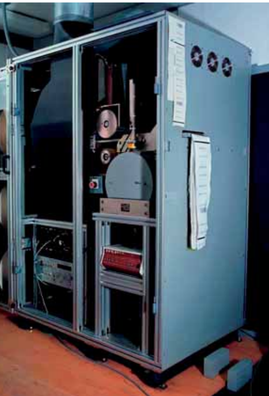
System zur Messung schwebstoffgebundener Radioaktivität für die Überwachung des CTBT
