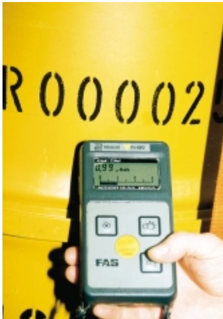
Abb. 27: Dosisleistungsmessung bei der Eingangskontrolle
