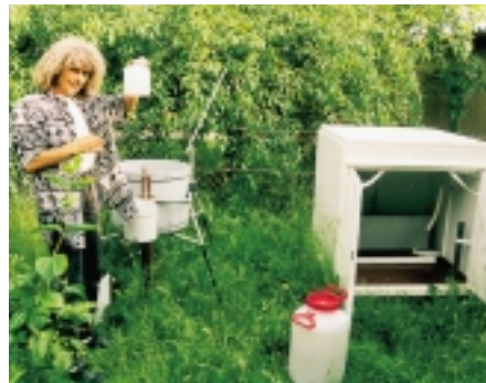
Abb. 33: Umgebungsüberwachung – Proben-nahme von Niederschlägen
