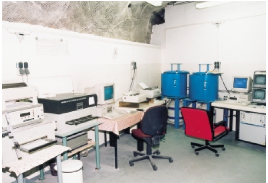
Abb. 28: Strahlungsüberwachungslabor unter Tage – Geräte zur Probenauswertung (v.l.: Staubfiltermessung, Wischtestmessung, Gamma-Spektrometrie)
