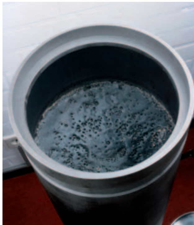
Verglaste Spaltproduktabfälle in einer unverschlossenen Kokille
