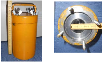
Transport- und Lagerbehälter für Strahlenquellen in geschlossenem und offenem Zustand.
